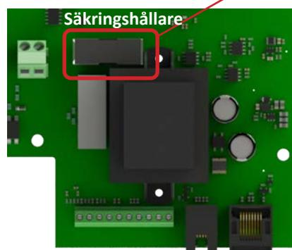
Säkringen sitter under knappskyddet bredvid transformatorn. Ta bort säkerhetskåpan och knappkåpan för att byta säkring. Om säkringen har löst ut visas en felindikering i programvaran. Endast behörig elektriker får byta säkring.
